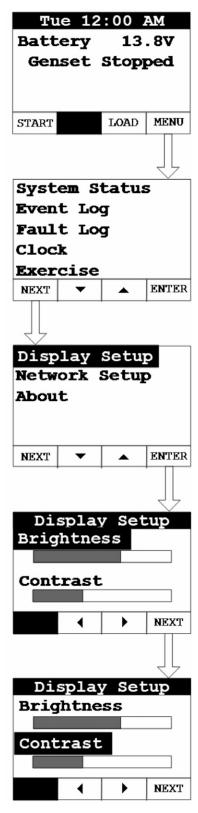
FIGURE 24. BRIGHTNESS AND CONTRAST SCREEN
