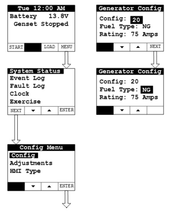
FIGURE 8. GENERATOR CONFIG SCREEN
