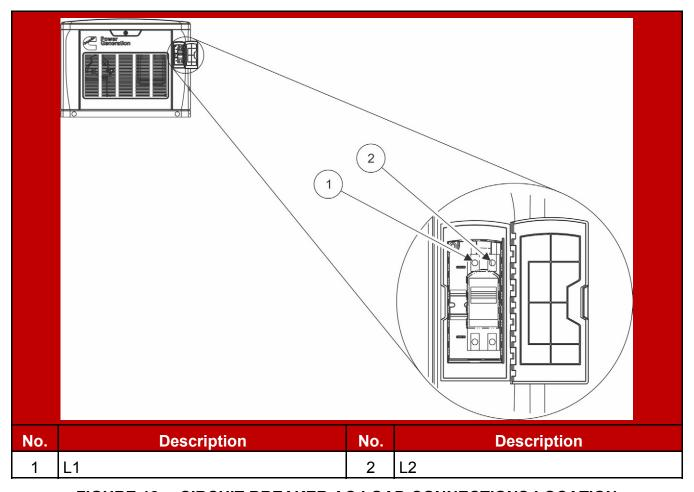
FIGURE 12. CIRCUIT BREAKER AC LOAD CONNECTIONS LOCATION
