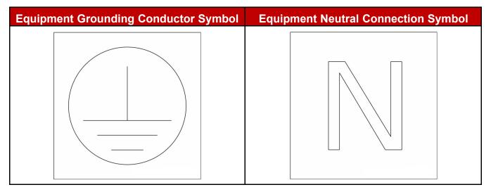
FIGURE 11. SYMBOLS ON CIRCUIT BREAKER BOX
