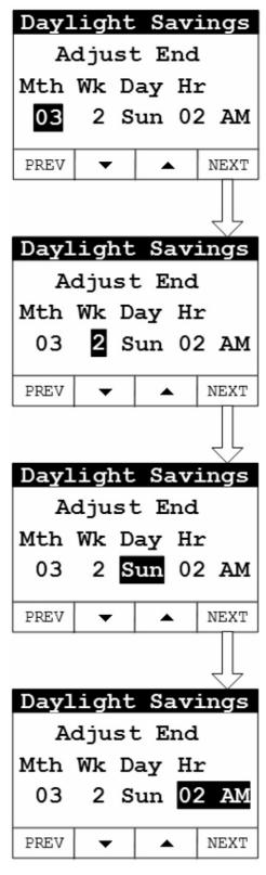
FIGURE 22. DAYLIGHT SAVINGS TIME (END TIME SETUP)
