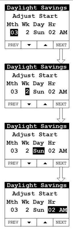
FIGURE 21. DAYLIGHT SAVINGS TIME (START TIME SETUP)
