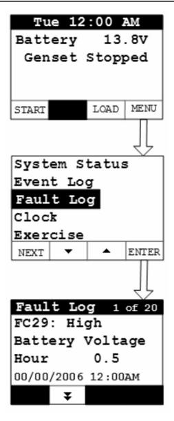
FIGURE 27. FAULT LOG SCREEN
